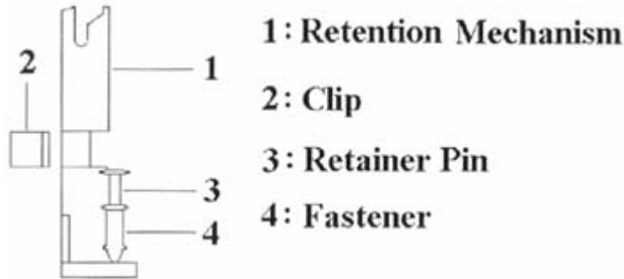
安裝 CPU 固定架及 Pentium II 中央處理器 [ Mount the Universal Retention Mechanism (URM) and PentiumIICPU ] (以下圖示只是參考例圖, 實際固定架以出貨為準)
