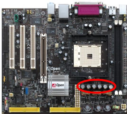
供應 CPU 核心電壓的電源電路一定要能確保 CPU 在高頻工作時的穩定性。典型的 CPU 核心電壓為 2.0V，所以一個好的設計必須將電壓控制在 1.860V 至 2.140V 之間，瞬間電壓則須低於 280mV。以下的圖形是由數位式示波器所截取下來的畫面，圖中顯示：即使接上高達 60A 的強大電流時，瞬間電壓也能控制在 143mV。
