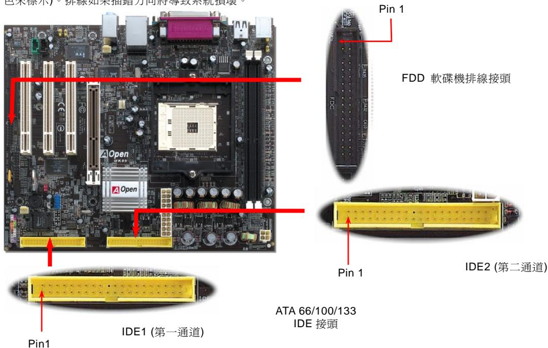
IDE1 為第一通道，而 IDE2 為第二通道。每一個 IDE 通道可以支援 2 個 IDE 裝置，所以 2 個通道就可以支援 4 個裝置；由於同一通道上裝置都連接在同一條排線上，所以裝置必須依設定區分成主裝置 (Master) 及次裝置 (Slave)。任何一個 IDE 裝置可以是一台硬碟或是光碟機，至於該裝置是主裝置 (Master) 還是次裝置 (Slave) 就依照該裝置之跳線而決定。此部分請參考您的硬碟機或是光碟機的說明書。
