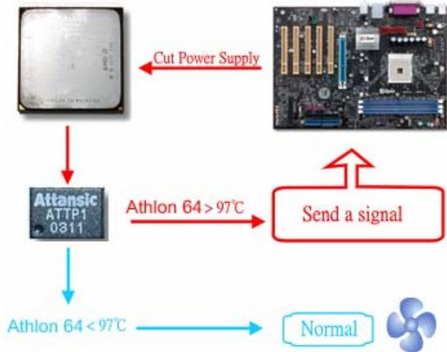
如果處理器散熱風扇正常運作的話，Athlon 64 處理器的工作溫度會遠低於攝氏 97 度。然而，處理器散熱風扇有可能突然故障或是安裝不當，這個時候處理器的溫度就會急劇攀升。如果主機板沒有 AOpen 過熱保護技術的話，使用者就會發現電腦當機、甚至會發現處理器開始冒煙了。有了 AOpen 過熱保護技術，當處理器過熱時，處理器的溫度感測針腳就會感測到電壓變化，此時過熱保護機制會及時送出訊號以切斷處理器的電源供應並瞬間關閉電腦，避免造成硬體損壞。AOpen 過熱保護技術是從電腦一開機即啟動純硬體監控而不佔用系統資源，不像其他廠牌主機板是由 BIOS 或軟體來控制斷電，比較不可靠。我們將此技術導入所有 AOpen AMD 系列的主機板中，以保護您的硬體設備及珍貴資料。
