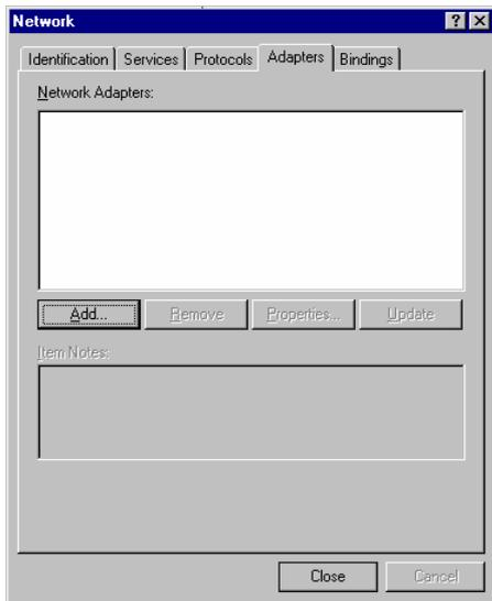
2. 點選“新增”安裝新的配接卡。您將可在「驅動程式清單」中看到已安裝好的配接卡。
