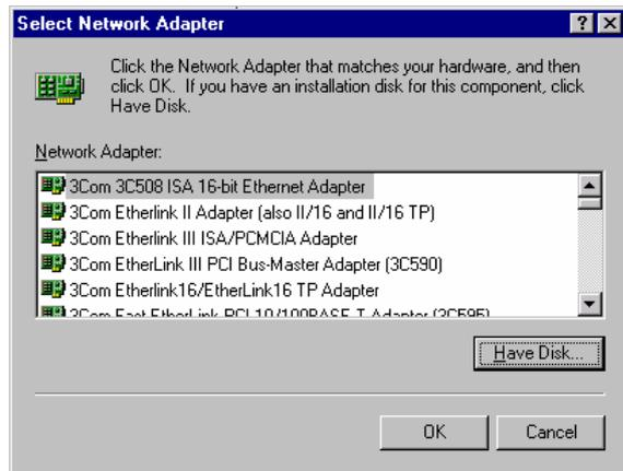
3. 在選取網路配接卡的畫面中，按一下“從磁片安裝”。隨著電腦的提示，置入紅利包光碟片，再於路徑文字盒中鍵入 "G:\Driver\LAN\RTL8100S-32\Winnt4"。點選 "確定"。
