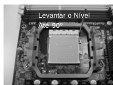
PASSO1: Levantar o Nível de Tomada Até 90°
