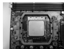
步骤 4： 下推并锁住插座拉杆
