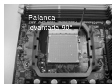
PASO 1: Levante la Palanca del Zócalo
