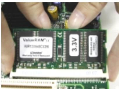
**Step 2:** Press Module down till clip hold.
