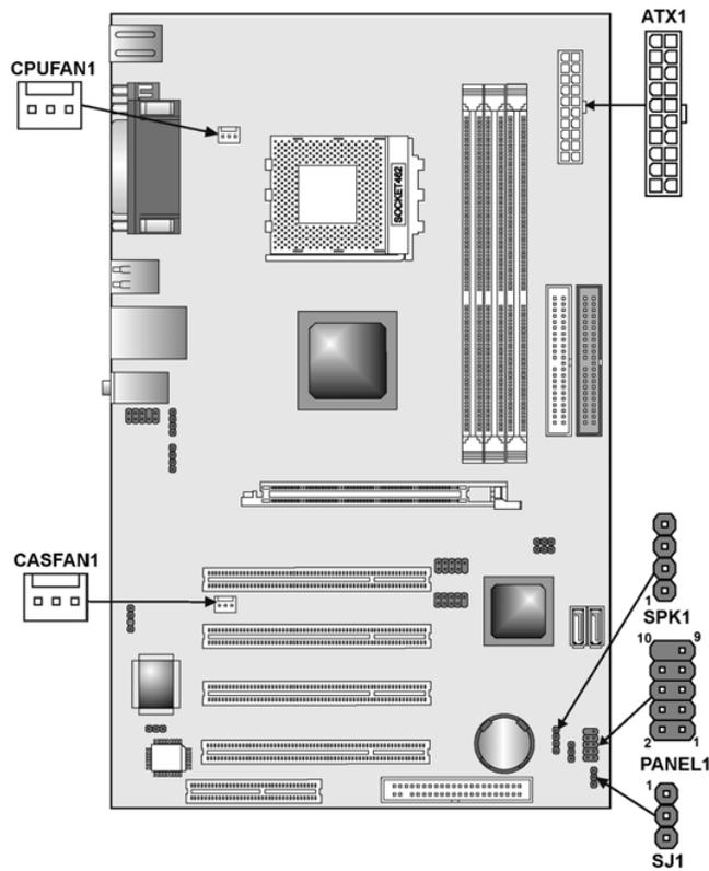
**ATX1: ATX 20-pin Power Connector**
