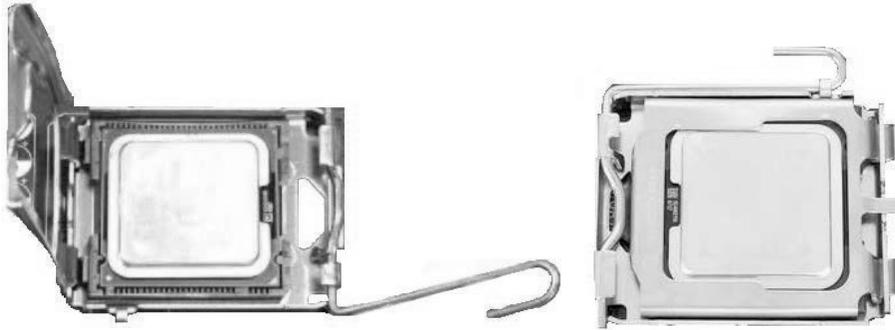
4. CPU上的缺口和插槽上的相匹配，固定在插槽中，若没有，请垂直向上取出CPU，并重新安装。
