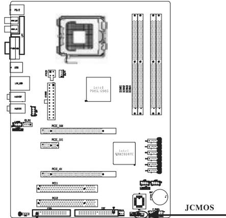
\* 如果主机板因为BIOS设置错误而出问题要清除CMOS，可在断开MATX电源状态下把CMOS跳线2-3脚短接至少两秒，然后返回1-2脚短接的状态。请不要在系统开机时清除CMOS，这样可能会对主板造成伤害。
