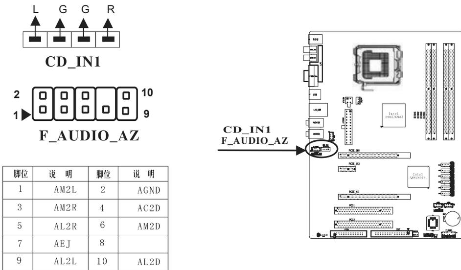
CD\_IN1为CD-ROM的音频接口；F\_AUDIO\_AZ为前置音频接口。如果你的机箱支持，那么你就可以方便地从机箱前面插拔音频设备了。
