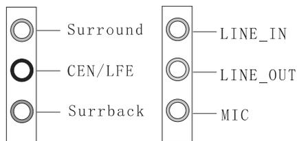
本主板提供六个音源插座，板载八声道，支持一个声音输入、四个声音输出和一个麦克风输入。通过操作系统的音频属性里的高级控制里选择打开和关闭八声道功能。但只有WINDOWS 2000/XP才支持此功能，WINDOWS 98不支持。音箱的具体接法参照音箱的说明书。
