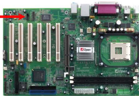
**說明：**雖然較新版本的 Windows 作業系統已提供“Digital Audio”的功能(藉由 IDE 排線輸出)，然而為了搭配能在 BIOS 中執行“Open Jukebox 音樂精靈”，請您**務必**安裝音源線。
