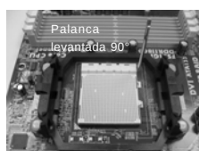
PASO 1: Levante la Palanca del Zócalo
