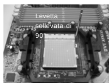
FASE 1: Sollevare la levetta socket
