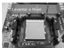
PASSO 1: Levantar o Nível de Tomada. Até 90°
