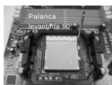
PASO 1: Levante la Palanca del Zócalo
