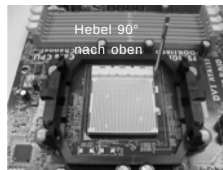
SCHRITT 1: Ziehen Sie den Sockelhebel hoch
