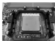
步骤 4： 下推并锁住插座拉杆
