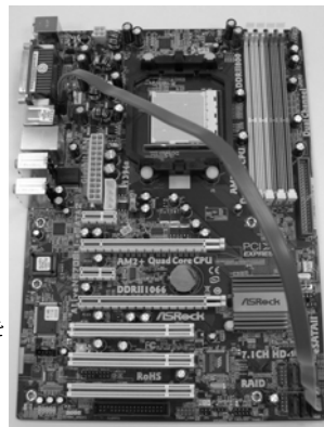
SATA データケーブルを eSATAII コネクタ (eSATAII_TOP) に接 続します
