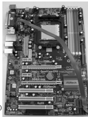
Collegare il cavo dati SATA al connettore eSATAII (eSATAII_TOP)
