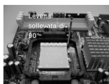
FASE 1: Sollevare la levetta socket
