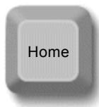
**ヒント:** オーバークロックにより、システム起動に失敗してフリーズした場合は、<Home>キーを押すだけでデフォルト設定に戻りますし、数秒待って AOpen “ウォッチドッグ ABS”がシステムをリセットしハードウェアが再度自動検出されるようにもできます。
