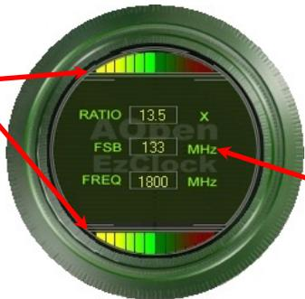
左の丸い部分には CPU レシオ、FSB およびクロック情報が表示されます。工場デフォルト設定では、丸の上下はグリーンになりますが、CPU 設定を変更するとそれに伴って変化します。
