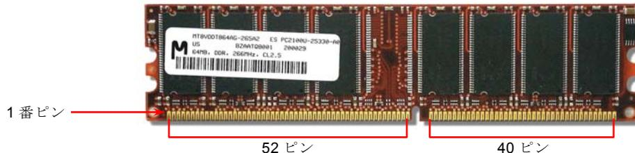
2. DIMM ソケットにモジュールを両手でまっすぐ下方に DIMM モジュールが止まるまで差し込みます。
