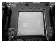
PASO 4: Apriete Hacia Abajo y Bloquee La Palanca del Zócalo
