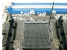
PASO 1: Levante la Palanca del Zócalo
