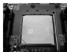
步骤 4: 下推并锁住插座拉杆
