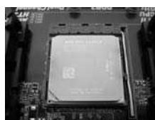
FASE 4: Abbassare e bloccare la levetta socket
