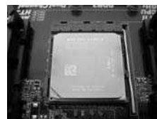
ETAPE 4 : Appuyez et verrouillez le levier de la prise
