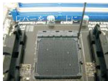
ステップ 1 ソケットレバーを持ち上げ ます
