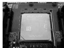
ШАГ 4. Прижмите и зафиксируйте рычаг гнезда.
