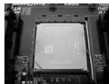
步驟 4： 下推並鎖住插座拉桿
