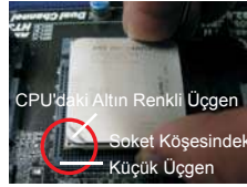
ADIM 2 / ADIM 3: CPU'daki Altın Renkli Üçgeni Soket Köşesindeki Küçük Üçgenle Eşleştirin
