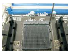
FASE 1: Sollevare la levetta socket
