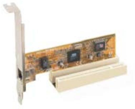
1. 关闭电脑电源,并且用手接触电源外盖以除去静电,然后拆开机壳。
