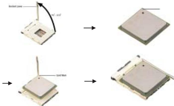
2. 将CPU水平放在ZIF插座上面，确定CPU第一脚（Pin 1）与缺角记号的位置与角度是跟插座上面的第一脚与缺角记号对应，缓缓地将CPU放入插孔中。如果没有阻碍力方向正确，。请注意方向与位置，并且确认CPU正确地插到够深的位置，不要使用太大的力气，以免对CPU造成损坏。
