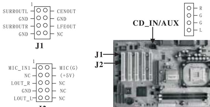
★主机板配有两个音频线接头CD\_IN、AUX和前置声卡J1、J2, 如果您的声卡支持六声道, 并且有六声道的音箱, 那么您就可以享受六声道音效的震撼效果。六声道时MIC和Line-IN接
