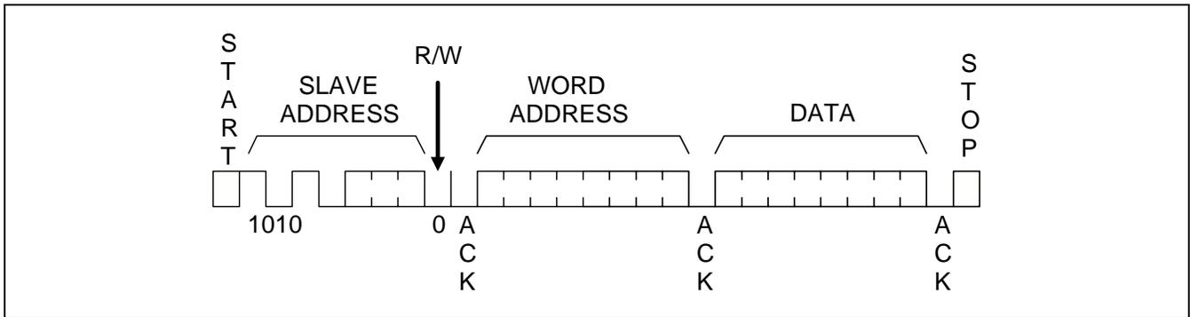
Figure 40. Serial Interface Byte Access-Read
